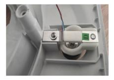
5. Den Hapro-AS-Waagebaustein in die Gegenform einlegen, ggf. festdrücken und die eingesetzte M3-Schraube festziehen.
